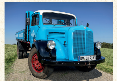
Mercedes-Benz L 312 Baujahr 1959 4,5 Tonnen Nutzlast 3,7 Tonnen Leergewicht Motor: Mercedes-Benz OM 312 100 PS / 74 kW bei 3.000 U/min Hubraum 4.580 cm 3
